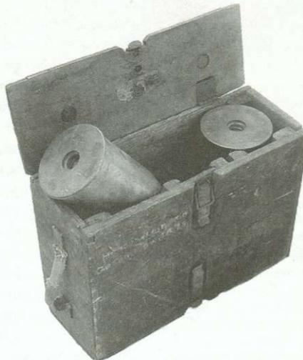
*Kiste mit zwei Kartuschen von 10,5-cm-Granaten für leichte Feldhaubitzen. Die Kartuschen, die den Treibsatz enthielten, wurden nach Abschuss der Granaten in Holzkisten an die Munitionsanstalten zur erneuten Befüllung zurückgeschickt. Zur friedlichen Nutzung wurde der Kartuschenboden abgeschnitten und das Kupferblech der Hülse ausgebreitet. (Foto: K.-G. Beringer)*
